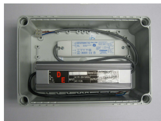
Netzteil und Dimmodul in Abzweigdose
