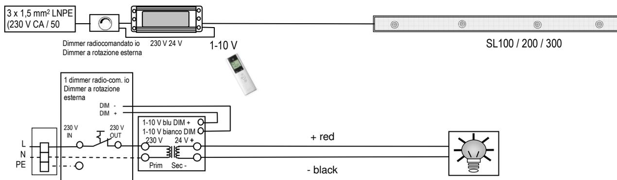
**Importante: Collegare al massimo 1 unità di alimentazione o alimentatore per ogni radiorecettore.**
