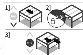
**Aby podnieść napędzany produkt do górnego położenia krańcowego,**
